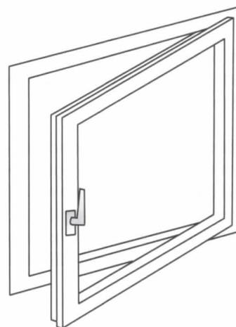
3. Drehen Sie den Griff um 180° nach unten in die Verriegelungsposition.
