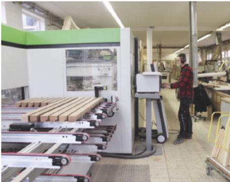
*/ Der Beladepuffer fasst bis zu 30 Werkstücke und ermöglicht autonome Bearbeitung bis zu einer Stunde.*
