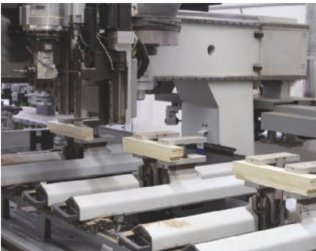
*/ Voll automatisierte Einzelteil-Komplettbearbeitung: Die Spannangen sorgen für beste Bearbeitungssicherheit.*
