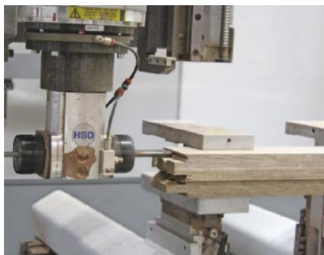
*/ Das Fräsaggregat mit zwei Ausgängen im Einsatz: Anfräsen der Zapfen für die PlugTec-Eckverbindung.*
