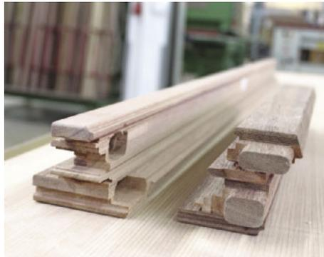
*/ Angefräste Zapfen und Langlöcher: Die PlugTec-Eckverbindung hat Werner Hartung sofort begeistert.*
