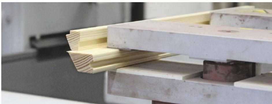
*/ Selbst sehr schmale Profile bis minimal 20 mm Breite werden für die Bearbeitung stets mit zwei FingerClamps sicher gespannt.*
