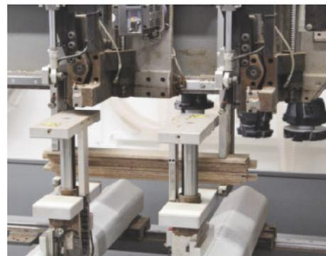
*/ Präziser Wechsel: Das Umspannen des Werkstücks zum Längsprofilieren der zweiten Längsseite.*
