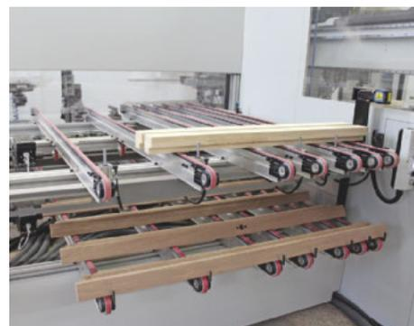
*/ Die Rahmenteile werden nach der Bearbeitung automatisch zum Ausgangspunkt zurücktransportiert.*
